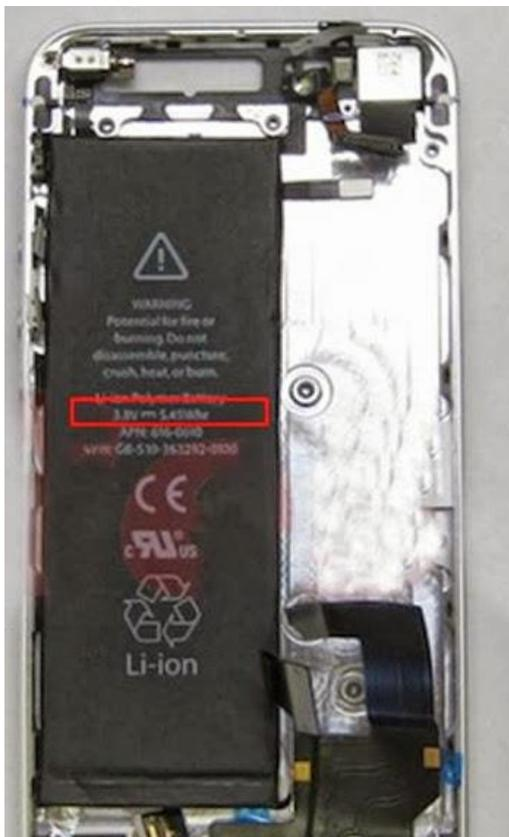
由於鋰電池一般的工作電壓是 3,7V，但輸出必須升壓到 5V，加上過程中一定會因升壓效率高低、控制版與線材阻抗，產生轉換損耗(轉換效率 88%-70%不等)，所以行動電源可使用的電量大概只有內部電池總容量的 60%左右(視轉換損耗程度)，計算公式如下:
